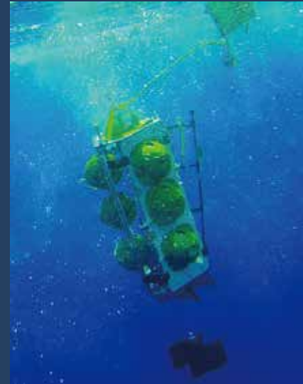
バッテリーを増強し、長期環境モニタリングが可能になった「江戸っ子1号365型」
