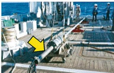
採取した海底下の柱状試料
